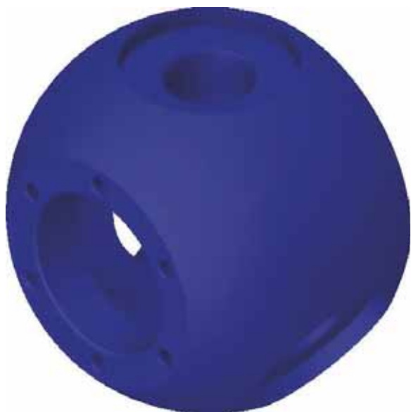
4. ábra. A G162 jelű szivattyú állítható járókerék lapátokhoz közvetlenül csatlakozó agyrész 3D geometriai modelljének izometrikus nézeti képe
